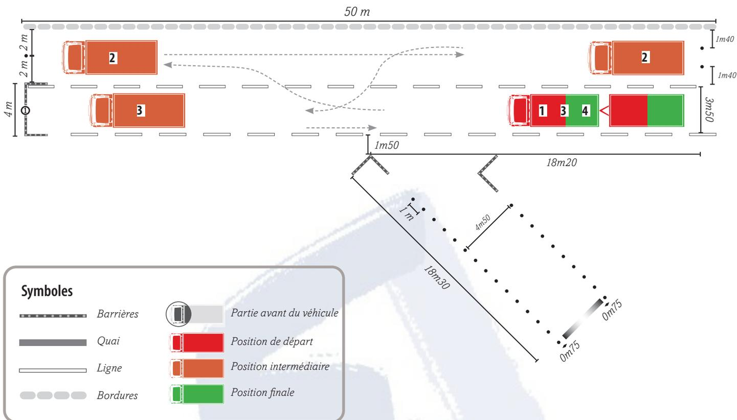
Le véhicule se trouve en position de départ lorsque l'avant du véhicule est à hauteur du bord extérieur de la barrière de gauche. Pour cette manœuvre, il vous sera demandé de porter des gants de sécurité.
